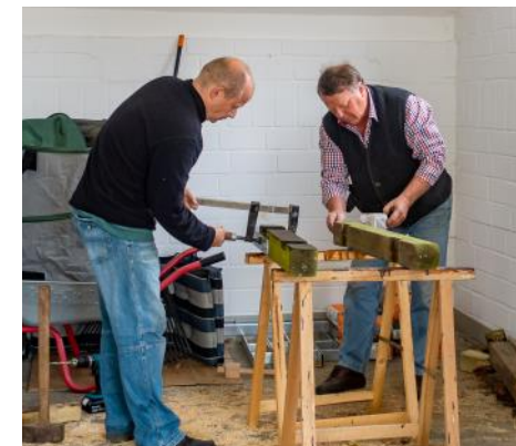
Vor dem Einsetzen werden die Zaunpfähle mit den H-Eisen verbunden
